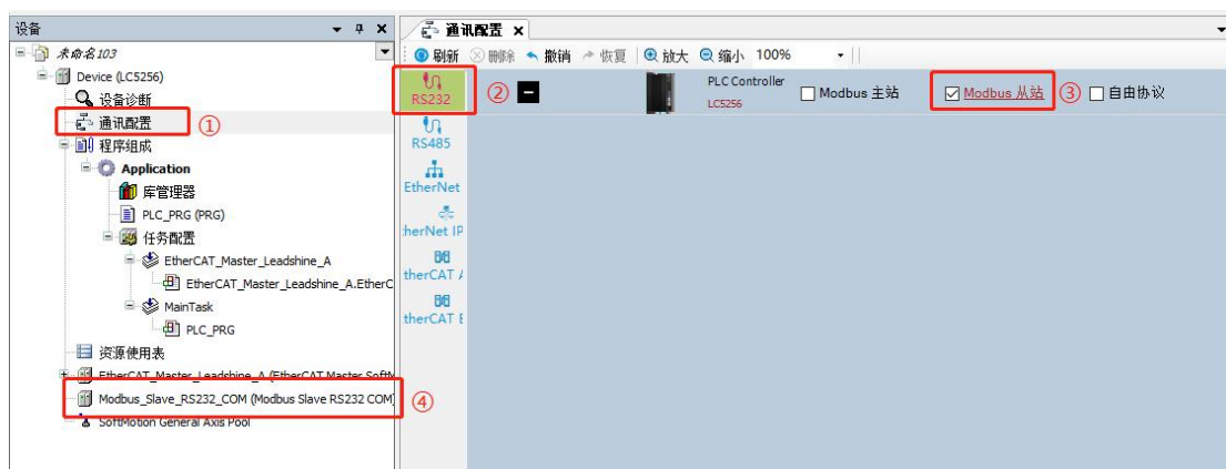
图 12.40 使能 PLC 作为 RS232 Modbus RTU 从站
