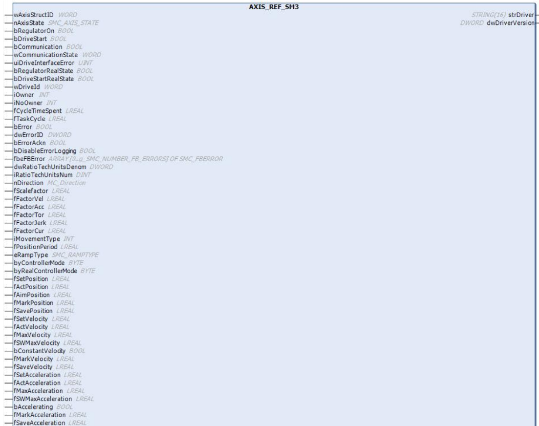
图 6.42 AXIS_REF_SM3 中的轴变量
