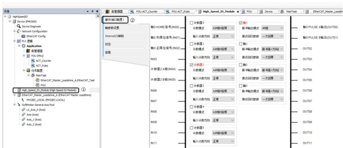
图 10.10 设置 PMC600 高速输入端口为计数器 2 和轴 0
