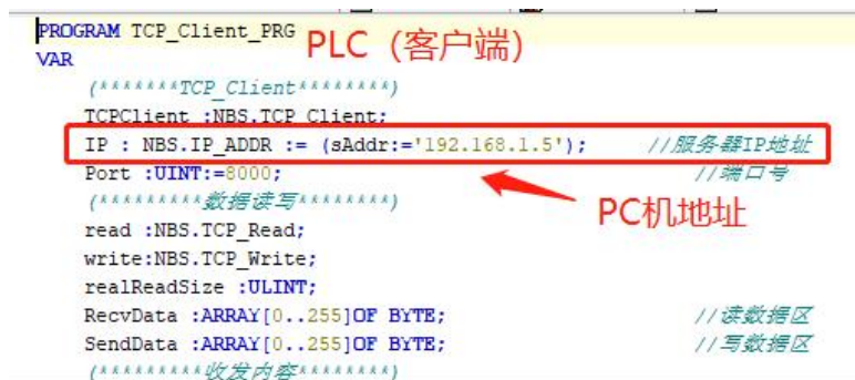
图 13.20 在 PLC 程序中设置 PC 机的 IP 地址
