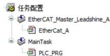
图 5.2 LC 系列 PLC 的任务配置
