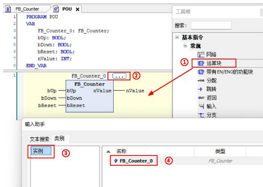
图 3.37 实例化功能块 FB_Counter
