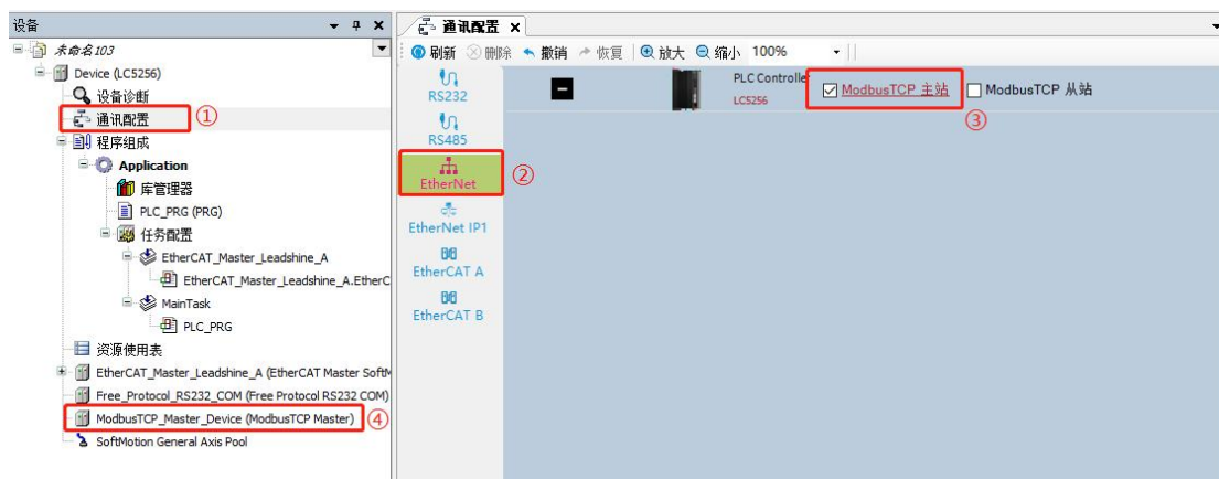
图 13.1 使能 PLC 作为 Modbus TCP 主站
