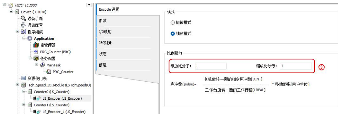
图 10.6 LC1000 高速计数器缩放比例设置
